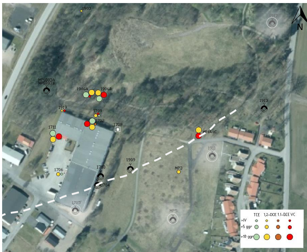
Figur 12. Uppmätta halter i grund- samt dränvatten i relation till ingripandevärde. 20 I figur har övergång till lermorän/moränlera från norr till söder hämtad från SGU:s jordartskarta tolkats in. Vit ring anger att klorerat lösningsmedel påträffats över rapporteringsgräns, men underskridande riktvärde.
