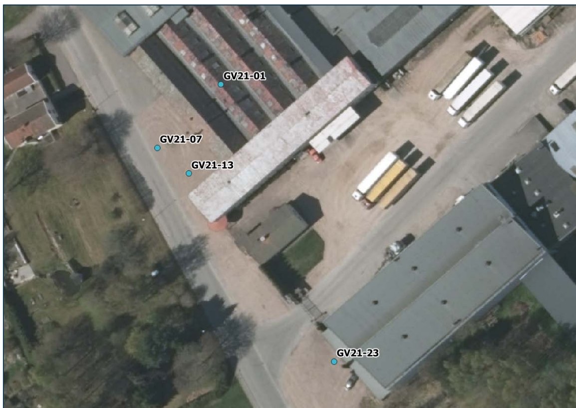
Figur 2. Installerade grundvattenrör 2021 vid platserna för oljeföreningar.
