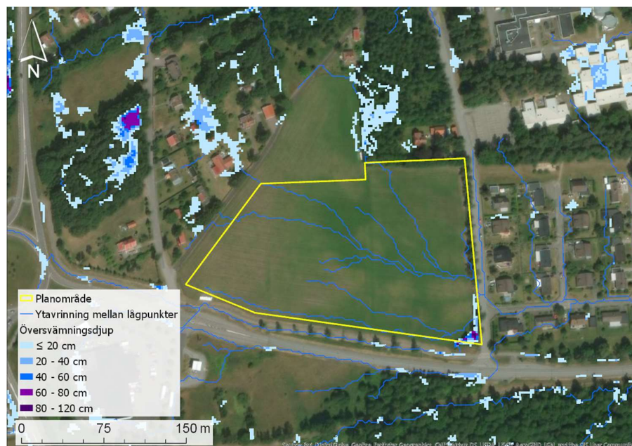
Figur 11. Karta som visar översvämningsområden vid ett 100-årsregn som faller på 10 minuter, motsvarande 37 mm, vid befintlig situation. De mörkblå linjerna visar hur vattnet rinner mellan lågpunkter.
